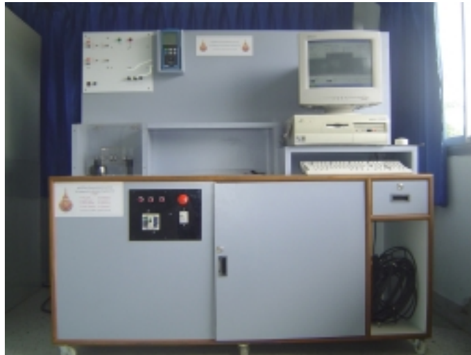
รูปที่ ผ1 ภาพรวมชุดเครื่องมือทดสอบหม้อแปลงจำหน่าย
